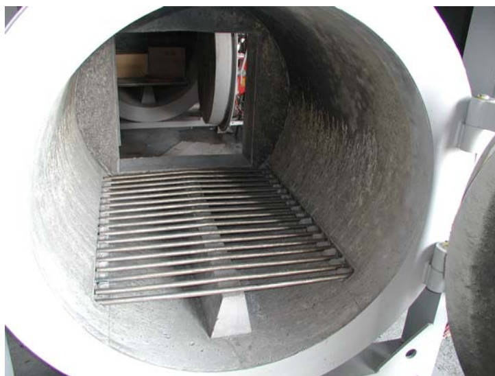
BIS 200, 75 kg/h Detail grating De-ashing (Dubai)
